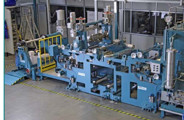
Beschichtungsoptionen: Beidseitige Lackierung über Walzenantragesystem, einseitige Beschichtung mit Breitschlitzdüse oder Rakel
