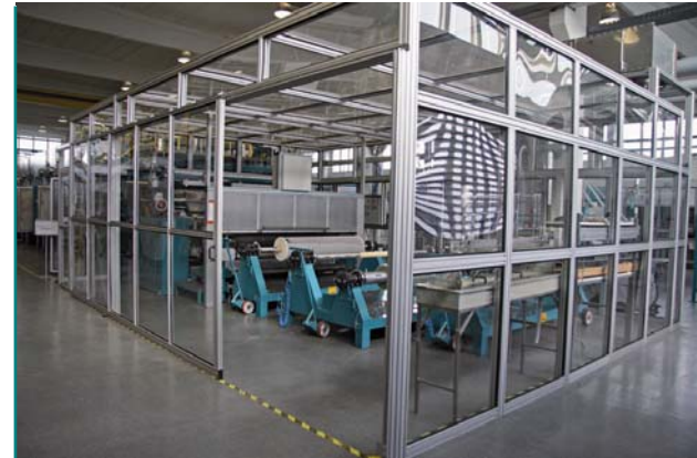
Staubfreie Qualitäten durch Einhausung der Anlage
