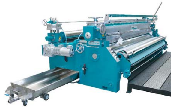
Coatema-Kombisystem: Multifunktionsanlage mit Walzenrakel, Luftrakel, Foulard und Walzenantragesystem
