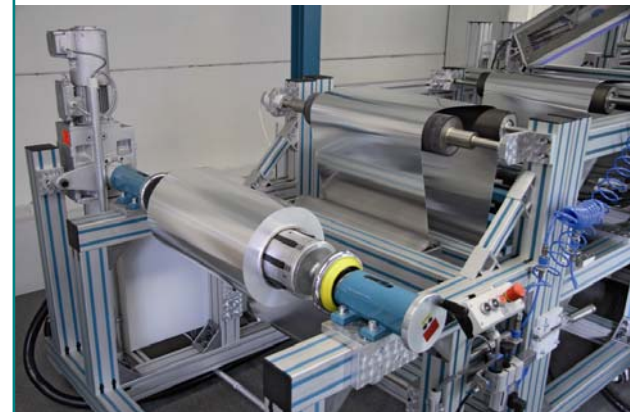
Abwicklung einer Click&Coat-Anlage
