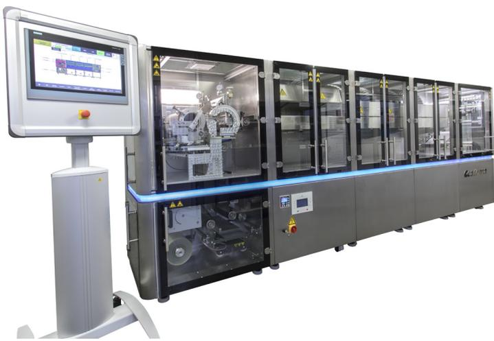
**Abbildung 1:** Smartcoater für Rolle-zu-Rolle Prozesse
